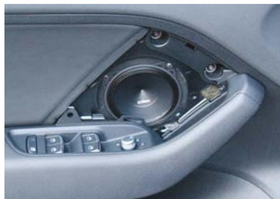
Per l'installazione di altoparlanti che sostituiscono quelli di serie, come nel caso del midrange, sono state sfruttate le strutture dell'auto e solo in casi particolari impiegati adattatori.
