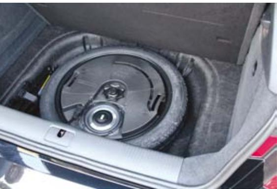
*Nel vano all'interno della ruota di scorta alloggiava il box in plastica del subwoofer di serie. L'installatore ha cambiato l'altoparlante scegliendo quello che meglio si adattava al volume a disposizione.*
